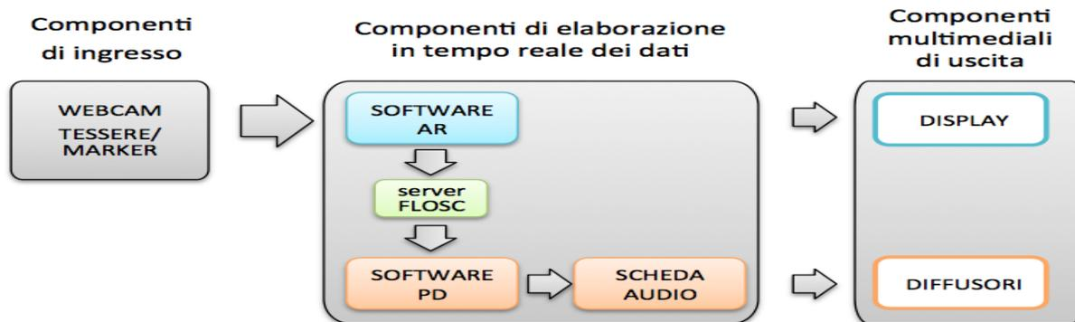
**Figura 3.** L'architettura di sistema del Memory Sonoro.
