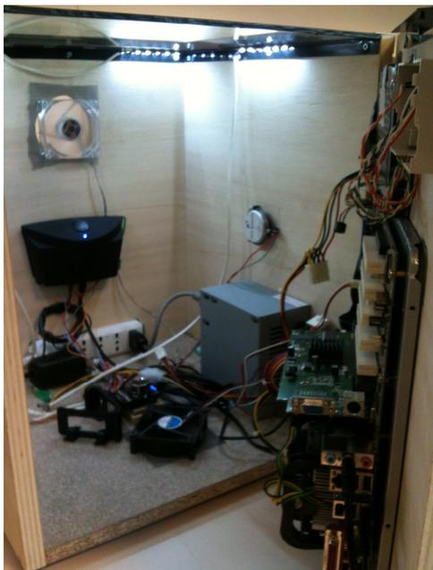
**Figura 1.** L'interno di EGLO: sono ben distinguibili la scheda pc e (sopra l'alimentatore) un *exciter*.
